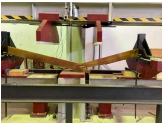
Foto 2: Ensayo de pieza de madera de pino silvestre modificada térmicamente.
