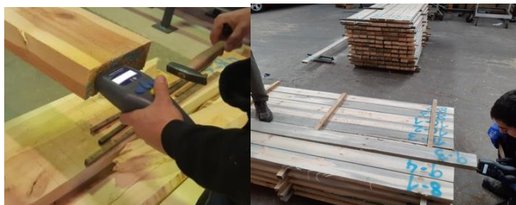
Foto 1: Equipo manual MTG de la casa Brookhuis y uso en madera aserrada en húmedo.
